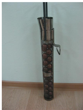
Рис. 2. Титановая корзина с медными шариками
